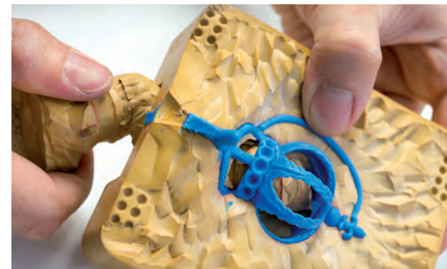
Um das Wachsteil unbeschadet aus der Form zu bekommen, zieht man die Hinterschneidung, den spiralförmigen Gummikern, vorsichtig heraus
