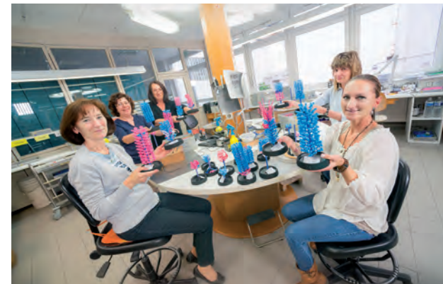
In der Aufsetzerei setzt man die Wachsteile behutsam zu Wachsbäumen zusammen
