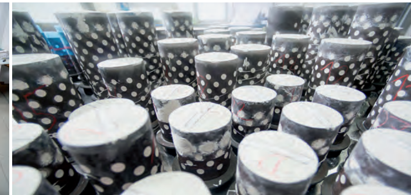
Anschließend werden die Wachsbäume in Kuvetten gestellt und in eine gipsartige Masse eingebettet
