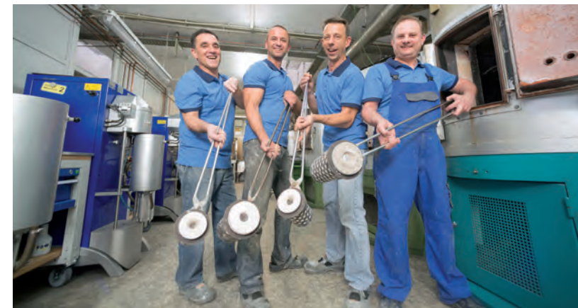
Nachdem das Wachs im Ofen ausgeschmolzen wurde, folgt der Guss durch erfahrene, langjährige Mitarbeiter
