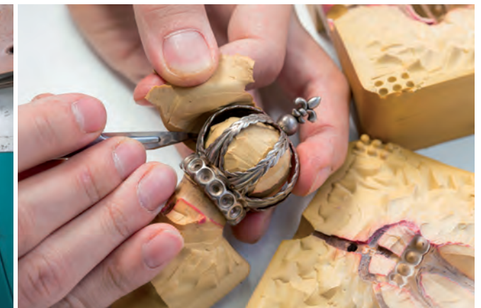
Fertigen der Gummi-Form mit einer sogenannten Hinterschneidung
