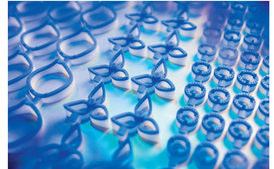
Sind die Wachsparts fertiggestellt, werden sie von der Bauplattform des Druckers entnommen und mithilfe einer Lösung von der weißen Stützmasse getrennt
