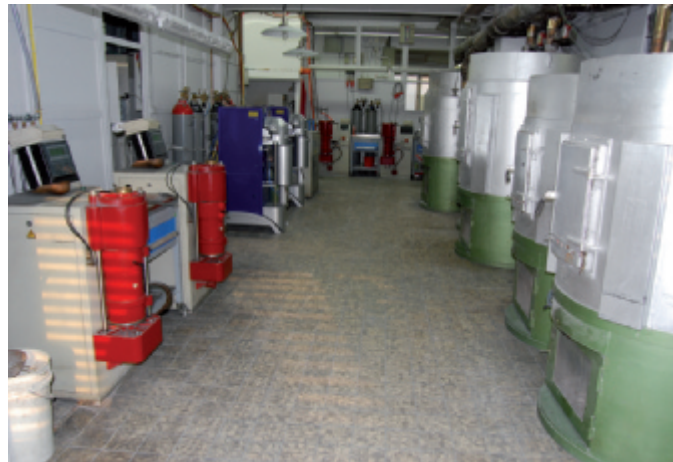
Blick in die heutige Gießerei mit 4 Schultheiss- und 2 Indutherm-Vakuumdruckgussmaschinen und 9 elektrischen Drehöfen für 210 Gusszylinder
